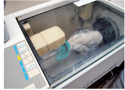
図6 庫内での洗浄から乾燥 ガラス蓋を閉じた後、洗浄・除菌・乾燥までの一連の操作を庫内で行う。
